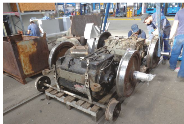
Při opravě byla repasována všechna ložiska jak nápravová tak tlapová. U některých ložisek byly odlity nové pánve.
