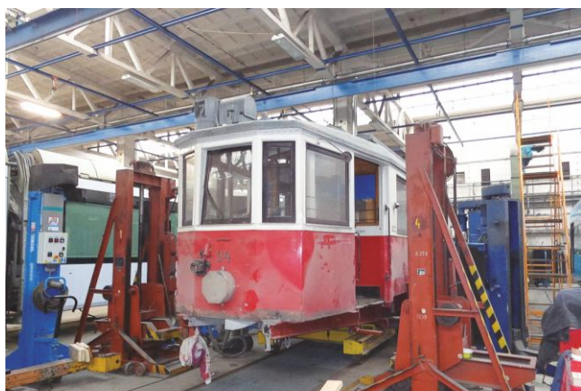
Zhoršení technického stavu, a to zejména mechanické části a oplechování vozové skříň vedly k rozhodnutí opravit našeho komárka.
