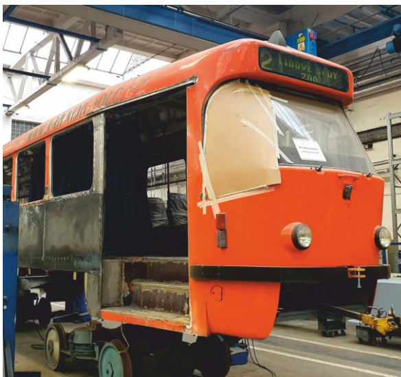
Oprava vozu 77 spočívá v odstranění poškozených částí bočnic, výměně za nové díly oplechování, a také v opravě schodů a dveří.
