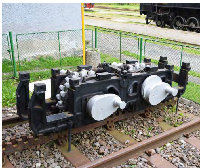
Pohled na dvounápravový ozubnicový pojezd. Na lokomotivě je zavěšený na tlakových ložiscích mezi první a druhou spráženou nápravou
