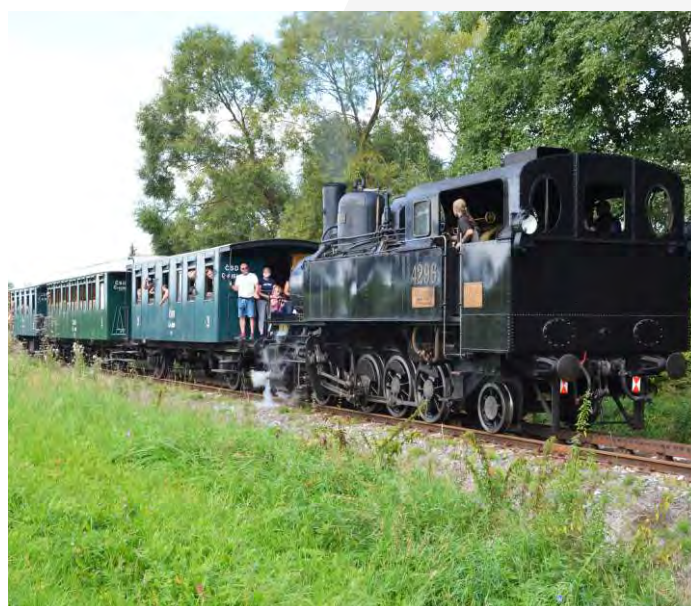
Při jízdě na ozubnici pracují současně oba parní stroje – adhezní i ozubnicový
