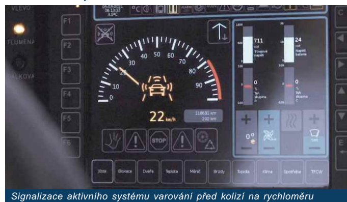
Signalizace aktivního systému varování před kolizí na rychloměru
