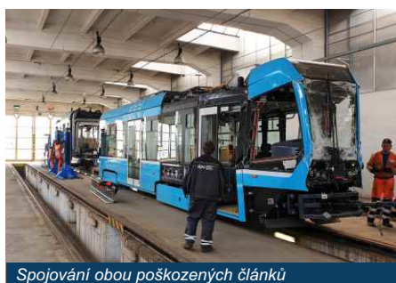
Spojování obou poškozených článků
