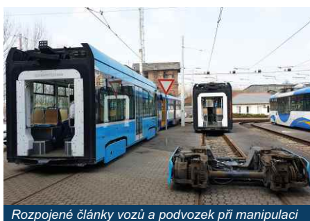
Rozpojené články vozů a podvozky při manipulaci
