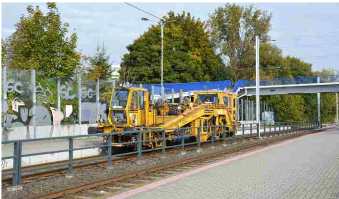
Geometrická poloha koleje byla upravena v úseku dlouhém 1939 m
