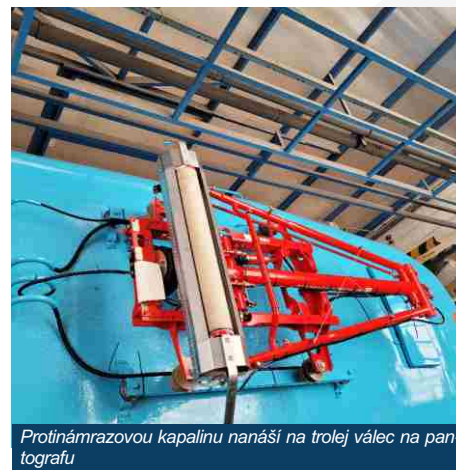
Zařízení je instalováno ve vozidle typu T3 č. 8211 (původně 977)
